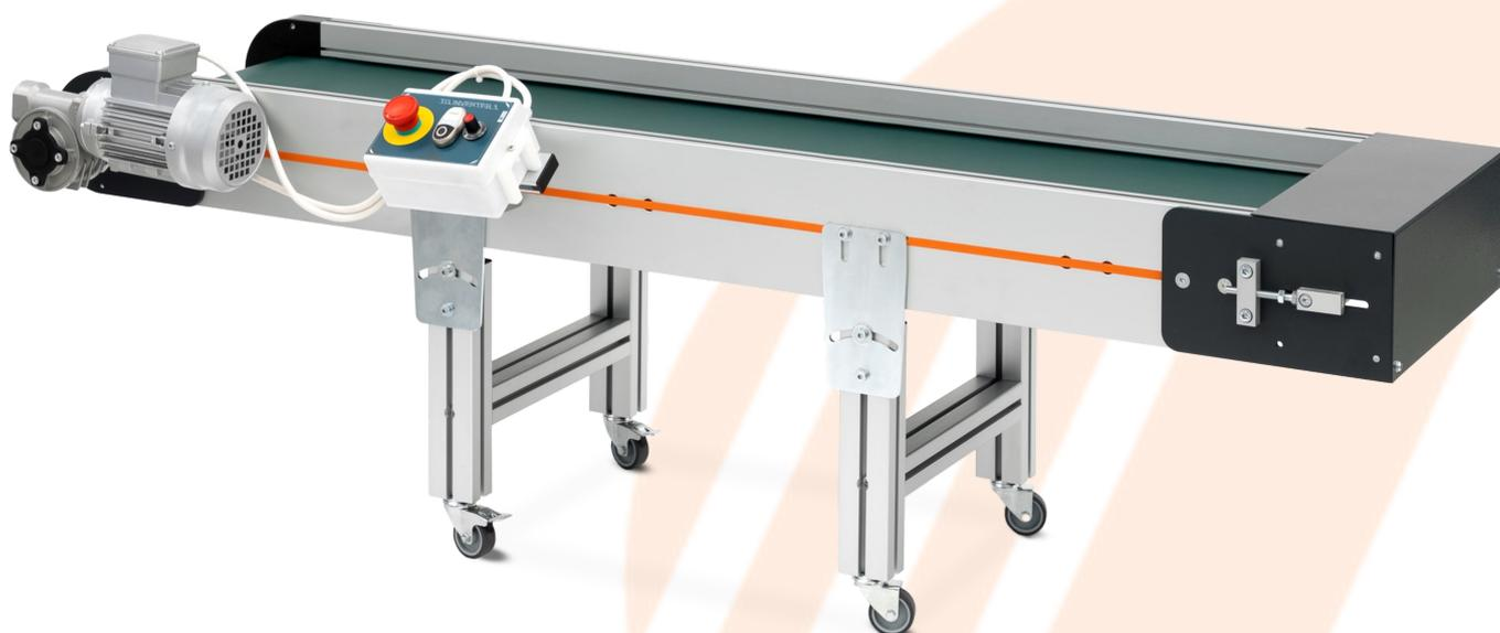
I nastri trasportatori Movitek Serie **MT-P** sono progettati per adattarsi a diversi utilizzi nel settore industriale. Realizzati in alluminio anodizzato, vengono forniti completi di tela di movimentazione, gambe di supporto ad angolazione variabile con ruote girevoli, motoriduttore ed impianto elettrico Start&Stop con regolatore di velocità ;
